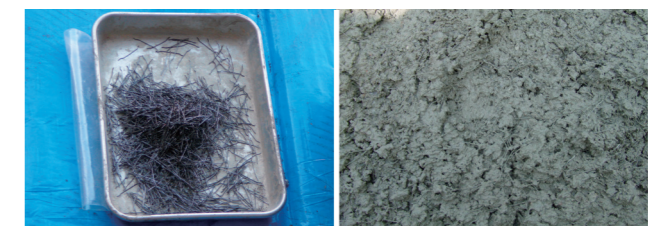
スチールファイバーとコンクリートへの混入状況
