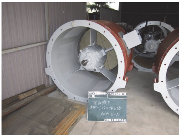
写真-1 ジェットファン電動機設置箇所
