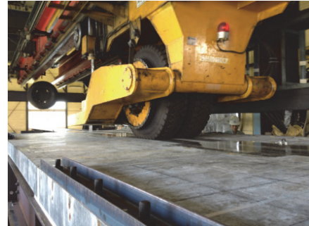
写真-2 静的載荷用ダブルタイヤ (100kN)
