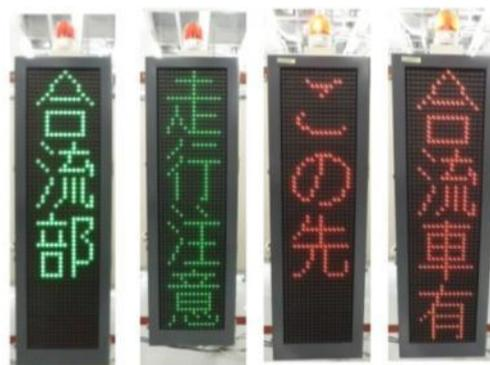
(a)合流車両がない場合の表示イメージ (b)合流車両検知時の表示イメージ
