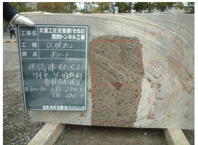
写真-5 コンクリートの切断面確認状況
