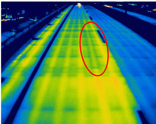
図-7 デッキ上面赤外線計測結果
