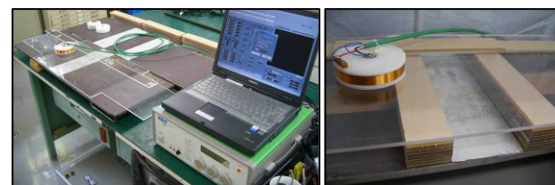
図-11 渦流探傷室内試験状況
