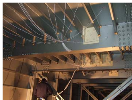
写真-4 スカラップ補強部計測状況
