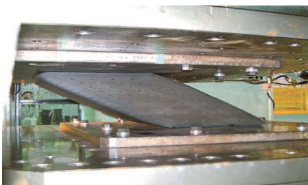
写真-1 せん断ひずみ250%時変形状況
