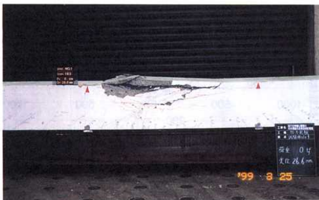
図-9 破壊モード (No. 1 試験体)
