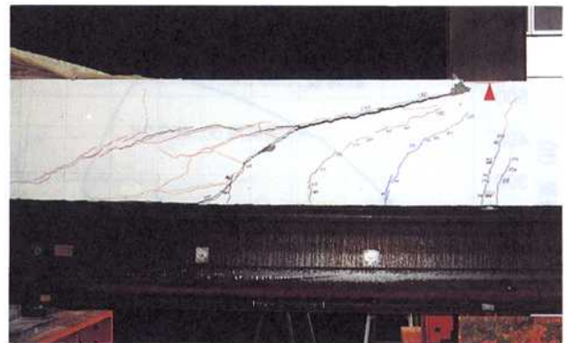
図-15 破壊モード (No. 3 試験体)
