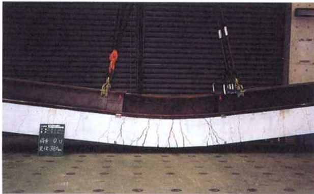
図-12 破壊モード (No. 2 試験体)
