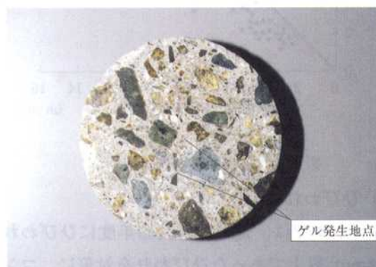
写真-3 コア断面にゲルが発生(養生10日目)
