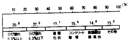
図-10 コンクリート橋脚損傷状況図
